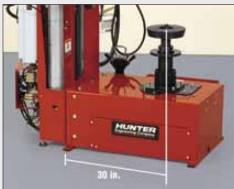
La position régulière est bonne pour les roues de 10 à 30 po.
