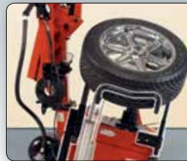
Elimina la elevación manual. Los contactos de la rueda recubiertos de polímero protegen el acabado en las ruedas personalizadas. (20-2201-1)
