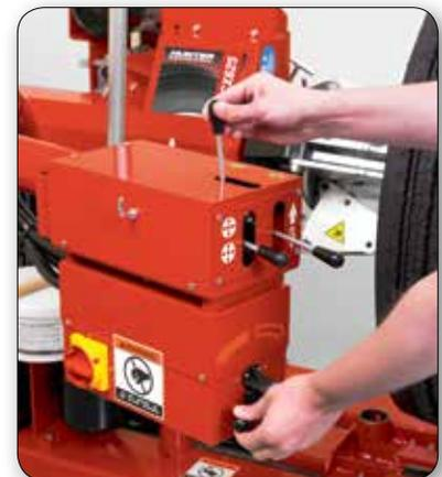
Todas las operaciones se controlan desde una caja de control individual. La caja de control hace pivote lo que permite que el técnico se mueva alrededor del cambiador de llanta según sea necesario.
