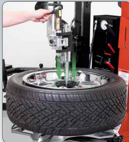
Los conos de prensa de rueda y el brazo de extensión simplifica la sujeción externa cuando realiza servicio a las llantas de perfil bajo.
