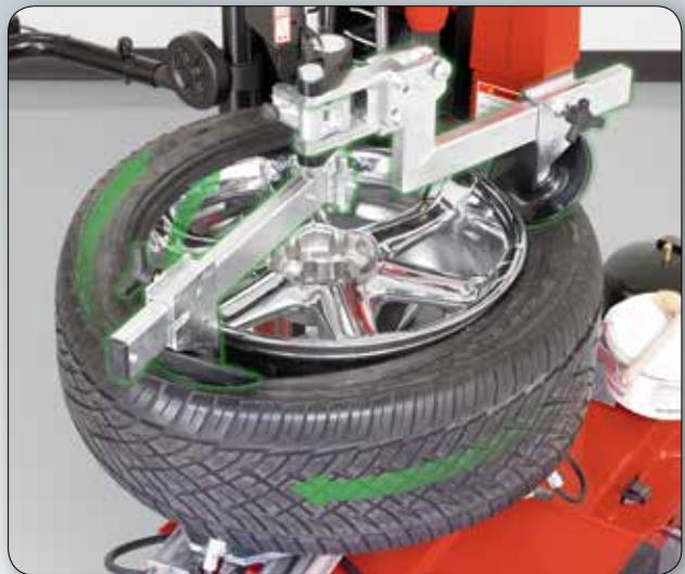
El brazo de prensa de talón fijo y volteado hacia abajo agrega contacto adicional para dar servicio a las llantas de perfil bajo más extremas y las ruedas de caída profunda.
