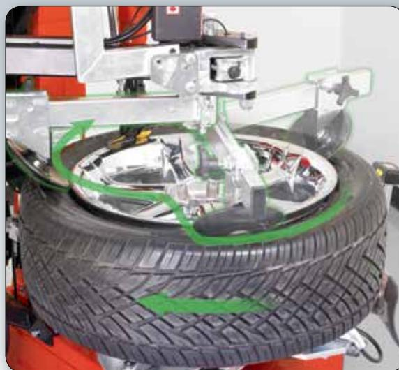
La acción de leva de elevación guía suavemente el talón a través del montaje.
