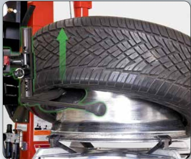
El disco de rodillo inferior se puede usar para volver a aflojar, desmontar o montar de forma concordante el talón inferior.
