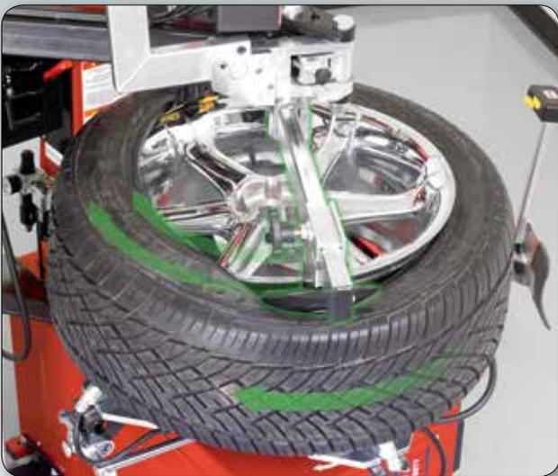
Un disco de rodillo de prensa de talón individual con brazo giratorio puede montar y desmontar rápidamente las llantas laterales rígidas.
