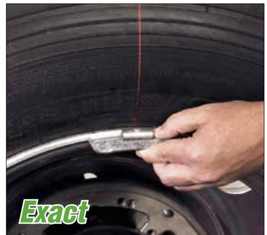
*L'emplacement précis des pesées est rapide et facile avec le laser HammerHead PMH comme guide.*
