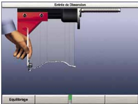
Le bras Dataset intérieur trace le contour de la jante et mémorise les distances et diamètres de localisations possibles choisis par l'utilisateur. Le balayage de jante inclut la fonction de localisation automatique de pesées pour augmenter les instances d'équilibrages rapides en utilisant la technologie SmartWeight®.
