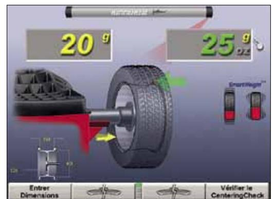
*Les lignes laser du point-mort-haut sont projetées sur le rebord de la jante pour montrer la position des pesées ou du point fort.*
