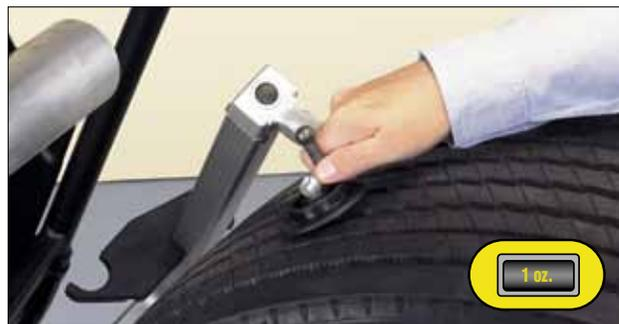
Le choix parfait pour le service de pneus et jantes surdimensionnés que l'on retrouve sur les 4X4 et les voiture modifiées. La correction avec Patch® règle les problèmes causés par l'excès de pesées sur les jantes en utilisant des pesées à l'intérieur des pneus. Les pesées sur les jantes peuvent être allégées et éliminées. Augmentez vos profits avec l'équilibrage de pneus surdimensionnés que les autres entreprises refusent.
