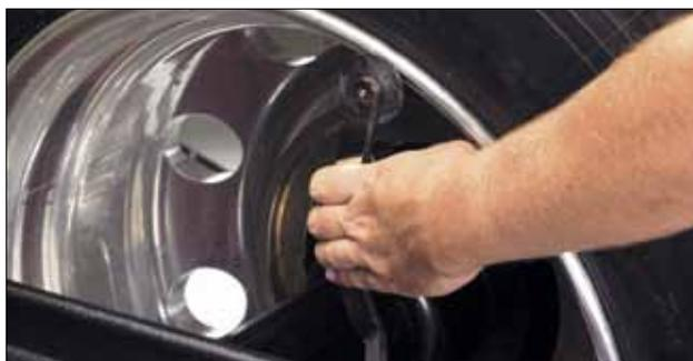
Le bras intérieur Dataset® détermine l'emplacement des pesées automatiquement pour des roues jusqu'à 30" (762 mm) de diamètre.
